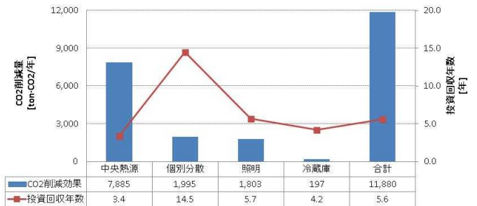
図5 各種対策によるCO2削減量と投資回収年数
